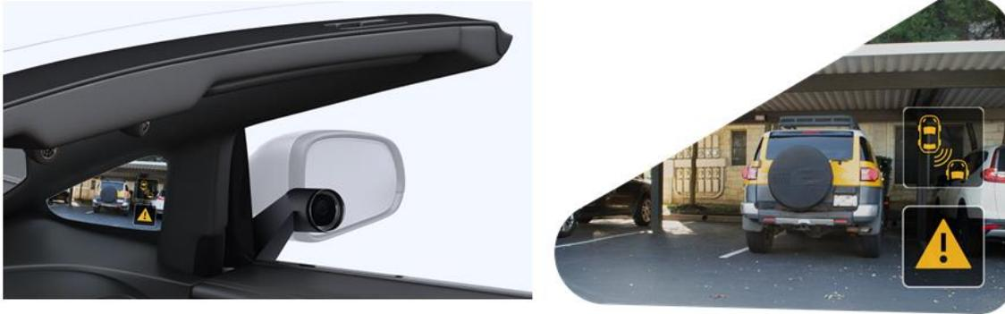
**James Goel:** 我们以汽车座舱的特定显示器为例，说明 MASS 如何让显示器得以支持更严格的功能安全目标。图中看到一个位置较低（low profile）、广角的汽车相机传感器，搭配嵌入式显示器，取代了传统的乘客座侧后视镜。改用数字后视镜之后，先进的光学系统减少了驾驶人的盲点，在夜间、低能见度、恶劣天气条件下也依然能发挥作用。它还具有额外的传感器功能，能侦测驾驶人可能看不到的物体和汽车。如图所示，汽车 ECU 分析了感测数据，并在屏幕上数字呈现了额外的安全标志和警告符号。这项应用中的车载显示器具有严格的安全目标，需要基于适当汽车危害分析的 ASIL D 认证。要能如此完整汇整，需要额外的像素信息，确保能符合 ISO26262 确立的 ASIL D 定义。
